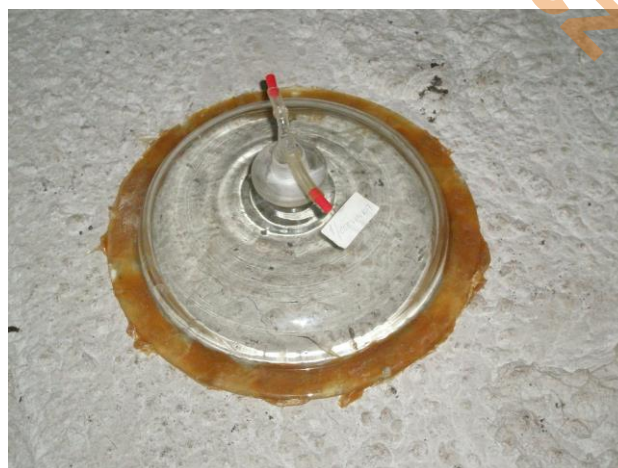
48 h utěsněný poklop (víko exsikátoru), z jehož prostoru bylo provedeno měření koncentrace amoniaku
