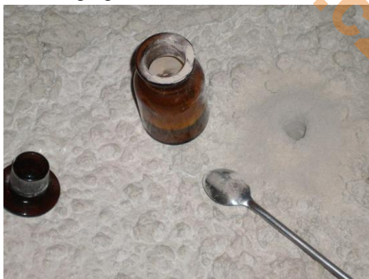
Odběr odvrtaného betonu k následné analýze
